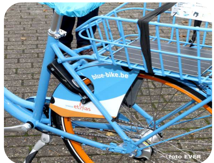
Het zonnepaneeltje liggend op de bodem van het bagagemandje. Morsum Magnificat heeft vragen over de mogelijke schade door de bagage en over de wijze van bevestigen.
