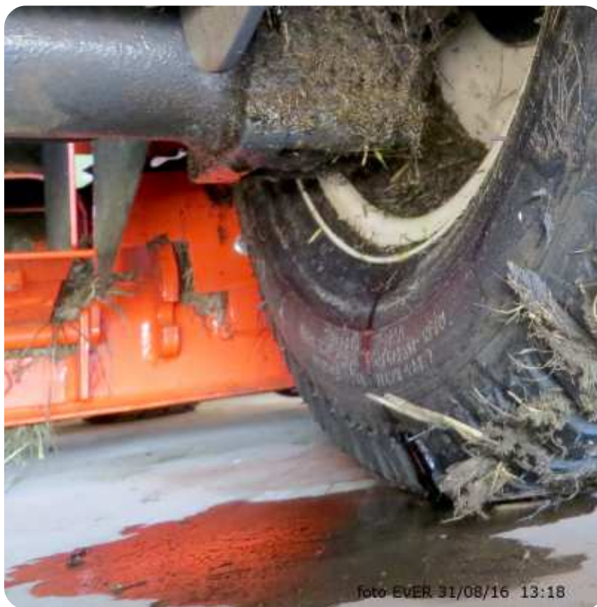
Voor de vierde keer binnen de maand na de levering, heeft de Kubota G21 een probleem, nu een ernstig olielek -foto inzet-.
