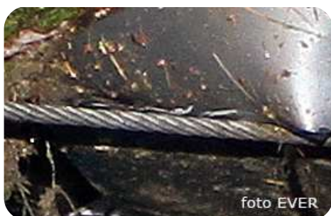
10mm kabel 1 x 36 WS, is niet geschikt voor gebruik op lieren.
