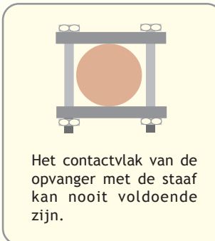
De Prevector werd bevestigd met de klem die dient om de daalleiding tussen te klemmen.
