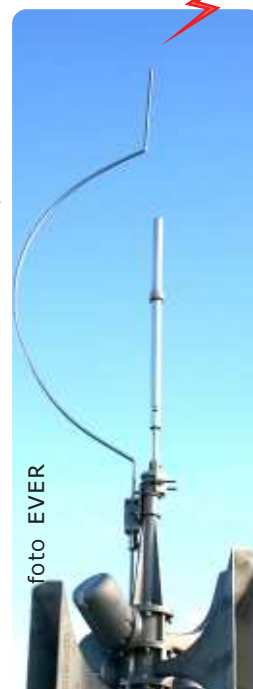
De RG8-U coaxiale kabel van de antenne op de motorfiets wordt hier op zijn plaats gehouden met een elastiekje ...
