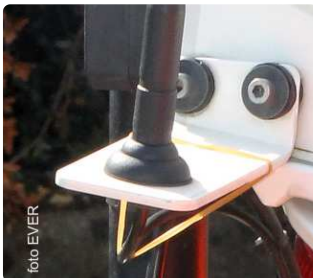
De RG8-U coaxiale kabel van de antenne op de motorfiets wordt hier op zijn plaats gehouden met een elastiekje ...
