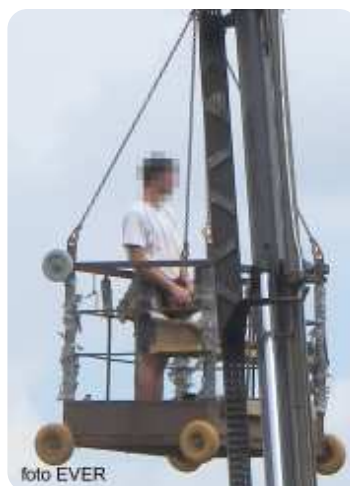
De hijskooi zou volgens Moors gekeurd zijn voor 500 kg last. Wij hebben geen identificatieplaat gezien.
