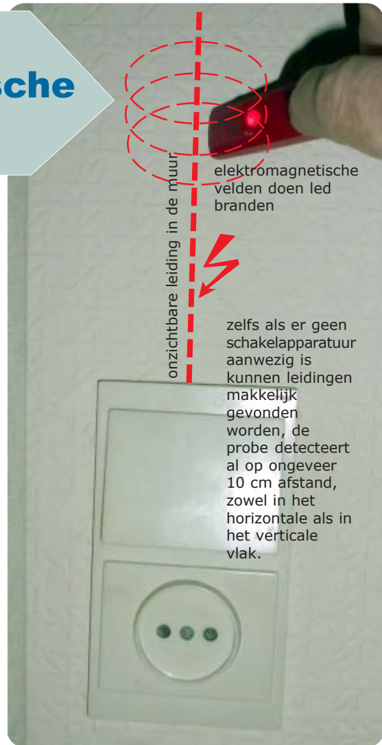
Eenvoudig detecteren van spanning verstoep onder bezetting en behang, in de muur
