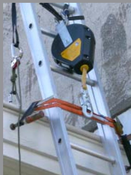
Fixation échelle Antichute
