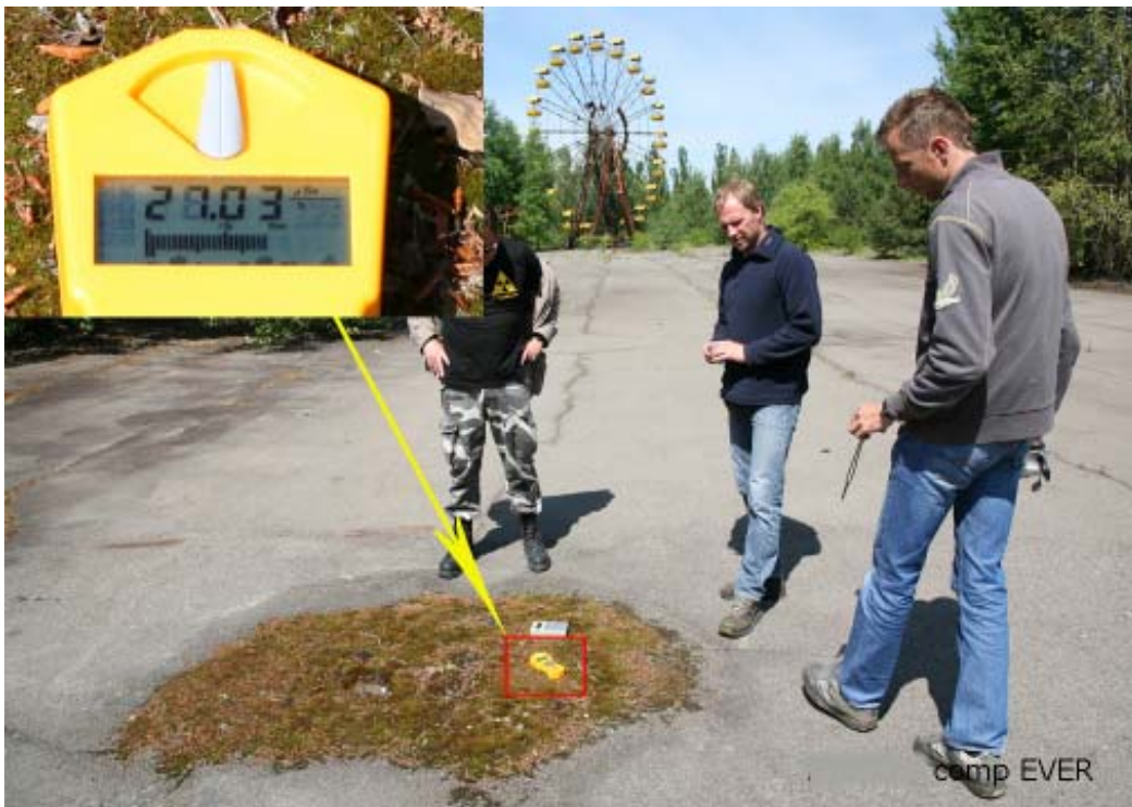
Resultaten gemeten op 21 mei 2009 : 27,03 \mu Sv/h met een dosis tempometer Gamma Scout
